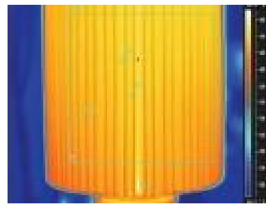
Wärmeübertragung im Dauerbetrieb.
